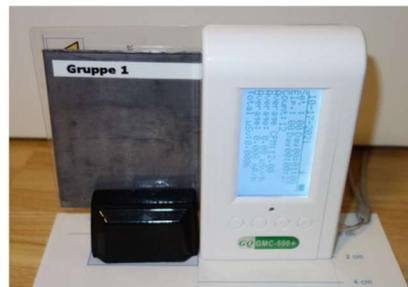
Die Messung erfolgt wiederum am **Thorium-Glühstrumpf**, der in der Schraubklemme befestigt wird. Die **Folie keinesfalls beschädigen, ausreichend Abstand** zum Glühstrumpf halten und nur **möglichst kurz** mit diesem **hantieren!** Daher wird auch bei diesem Versuch jeweils **nur eine Messung** durchgeführt! Die Messdauer beträgt jeweils 1 Minute.
